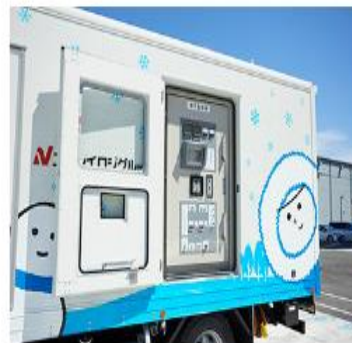
移動電源車 (関西電力資産)
